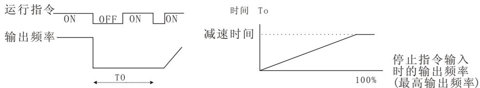
停止指令输入后, 在时间  $T_0$  经过以前, 将与运行指令无关, 时间  $T_0$ , 根据停止指令输入时的输出频率和减速时间来决定。
