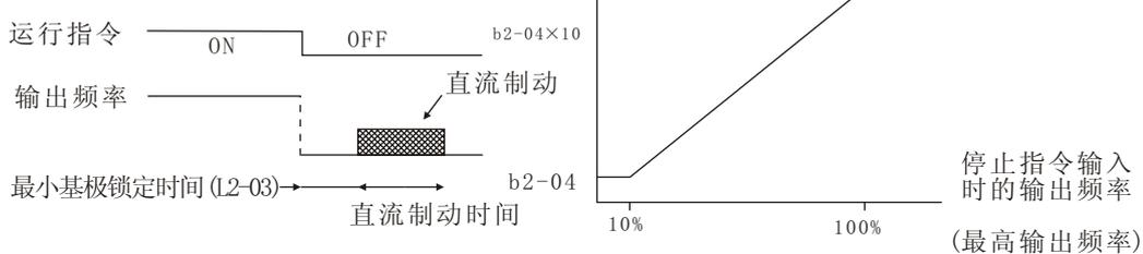
停止指令被输入了, 经过最小基极锁定 (BB) 时间 (L2-03) 后, 加上直流制动便停止了。直流制动时间, 根据停止指令输入时输出频率和停止时直流制动时间 (b2-04) 的设定值来决定。
