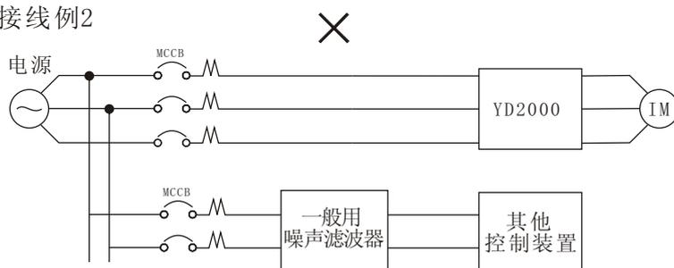
变频器的噪声，用一般的噪声滤波器效果很小，故不能用。
